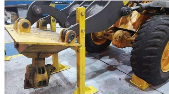
Calçamento do braço de elevação (atividades que impossibilitam a posição de Energia Potencial Zero). E travamento dos pneus.
