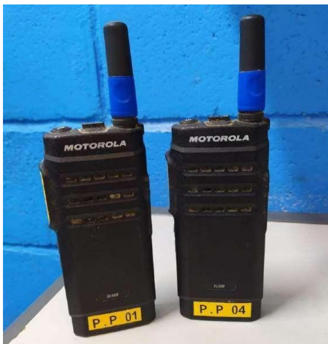
Rádio ponto-a-ponto para comunicação exclusiva com o operador do guindaste.
