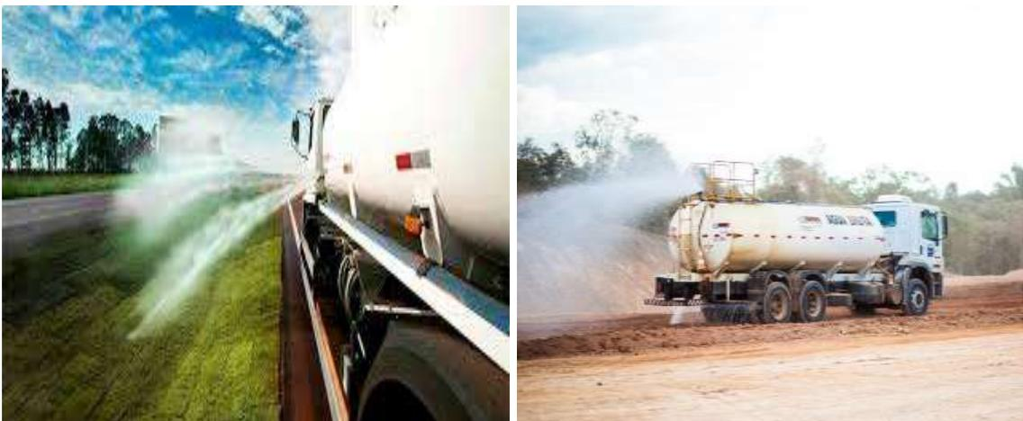
Figura 13 – Exemplo de atividade de irrigação utilizando caminhão pipa
